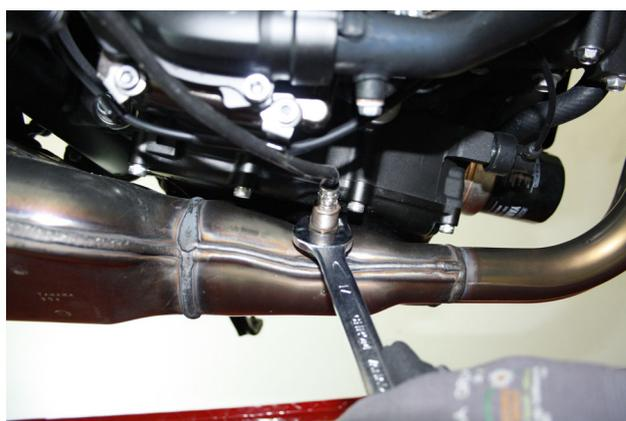
4. Lösen Sie nun die beiden Befestigungsschrauben des Endschalldämpfers unterm Motor. Lassen Sie jedoch die Schraube in Fahrtrichtung rechts noch montiert, so dass die Anlage später nicht herunterfallen kann.
