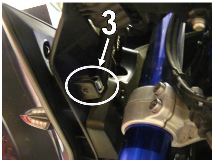
3. Ziehen Sie die Schutzfolie ab und setzen Sie die Gummieinsätze in die Bohrlöcher und dann die Metallhülsen in die Gummieinsätze ein.
