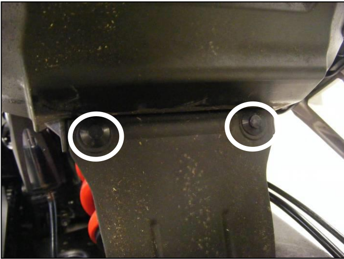
5. Entfernen Sie den Bremsleitungshalter
