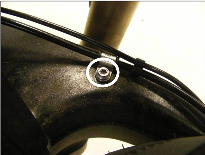
7. Setzen Sie die Abdeckung auf die Schwinge und befestigen Sie mittels der 3 M6x20 Schrauben an den Befestigungspunkten (Siehe Bild).
