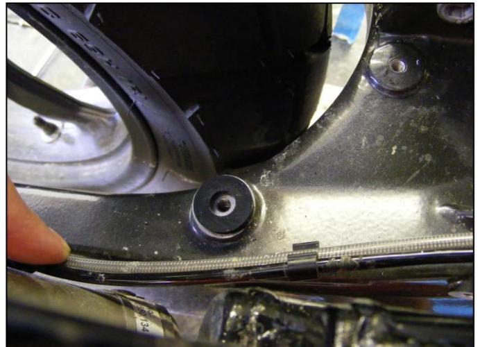
5. Befestigen Sie die Hinterradabdeckung mit den 4 M5x20 Schrauben wie auf den Bildern dargestellt.
