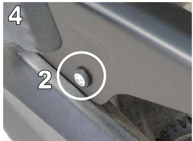
**WICHTIG: Überprüfen Sie regelmäßig die Ausrichtung der Hinterradabdeckung und die Spannung der Befestigungsschrauben. / IMPORTANT: Always check alignment of rear hugger and mounting bolts tension periodically.**
