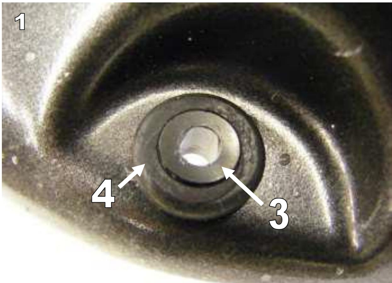
4. Schieben Sie die Hinterradabdeckung auf die originalen Gummidämpfer, siehe Abb. 2, auf und fixieren Sie die Hinterradabdeckung mittels der 2 M5x20 Schrauben an den Aufnahmepunkten siehe Abb. 3+4 / Slide Hugger on to rubber grommets, see Fig.2, and secure the hugger using the 2 M5x20 screws into fixing points, see Fig.3+4.
