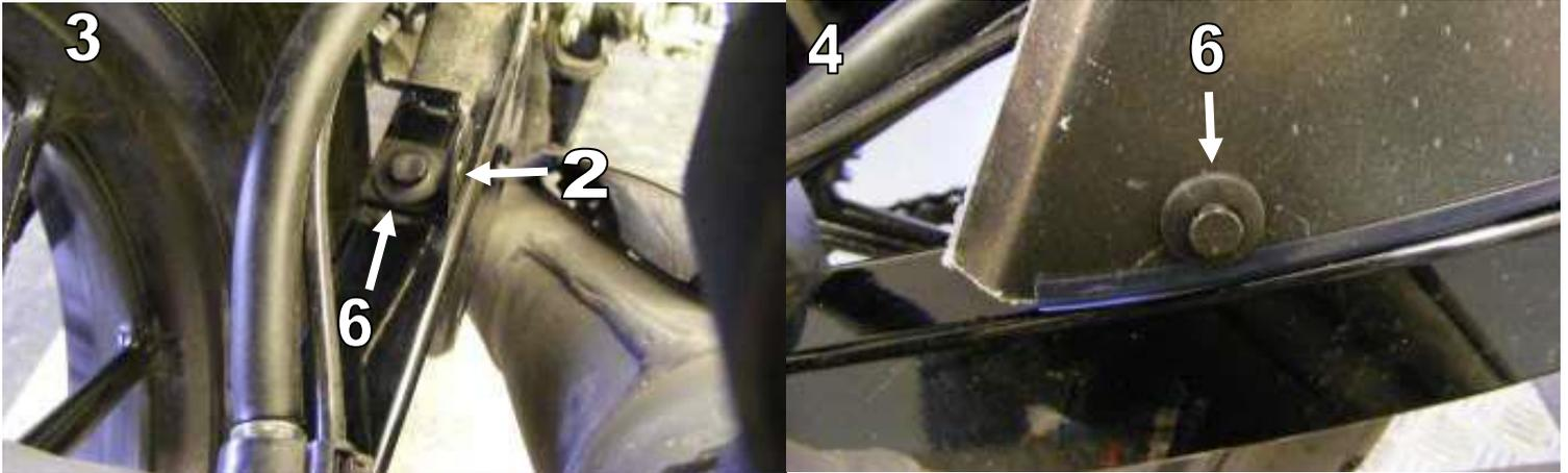
7. Befestigen Sie die Hinterradabdeckung (1) am vorderen Befestigungspunkt mittels der originalen Befestigung. Abb.5 / Fit Hugger (1) at front position using original fixing. Fig. 5.
