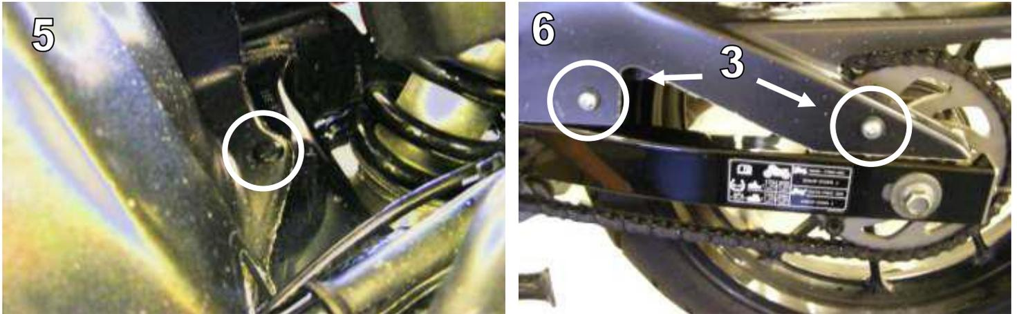
**WICHTIG: Überprüfen Sie regelmäßig die Ausrichtung der Hinterradabdeckung und die Spannung der Befestigungsschrauben. / IMPORTANT: Always check alignment of rear hugger and mounting bolts tension periodically.**
