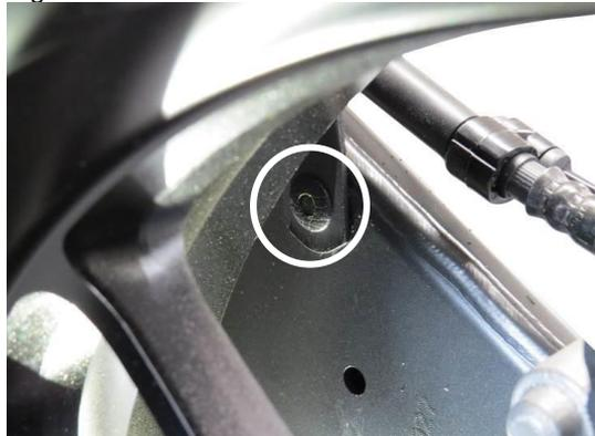
Zuletzt befestigen Sie wieder die linke Fahrerfußraste mittels der Original-Schrauben. / *Finally, attach the left driver footrest again using the original screws.*
