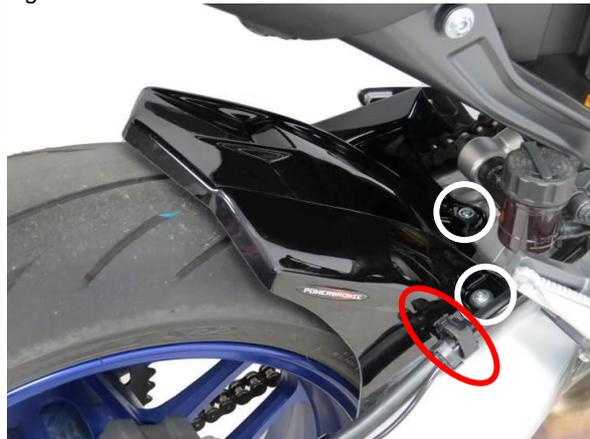
7. Fixieren Sie den langen „Arm“ der Radabdeckung in Fahrtrichtung rechts auf der Innenseite der Schwinge anhand der originalen Druckniete. wie in Abb. 7 gezeigt. / *Secure hugger using original push pin fixing to swing arm as shown in Fig. 7*
