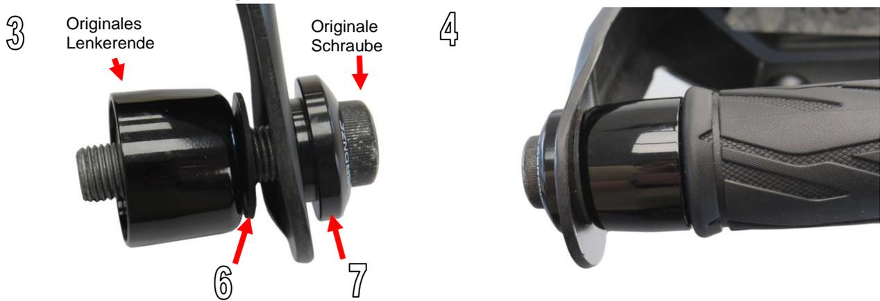
6. Befestigen Sie die Handschützer mit der M6x20-Schraube (4) und der M6-Flanschmutter (3) an den Halterungen. Ziehen Sie die Lenkerendschraube fest, sobald sie an den Halterungen angebracht ist. Abb.5 / Fit the hand guards to the brackets using M6x20 socket screw (4) and M6 flange nut (3). Tighten bar end screw once fitted to brackets. Fig.5
