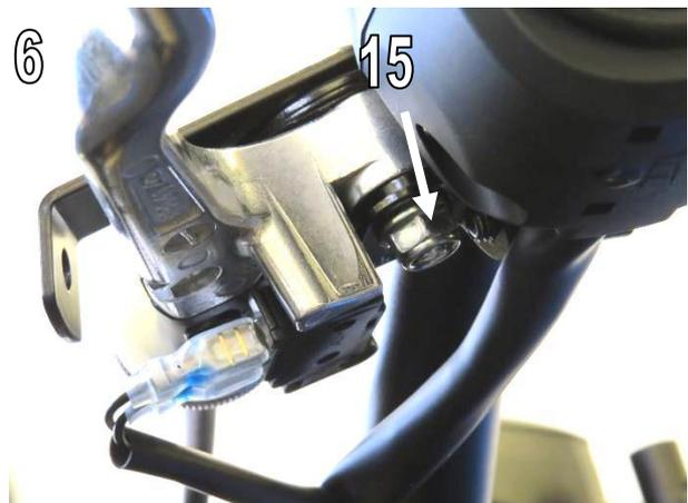
8. Handprotektoren mit Lenkerendeinsätzen montieren und Innensechskantschraube M6 x 70 anziehen. Befestigen Sie die Handschützer an den Halterungen mit M6 x 18 (4) M6 Flanschmutter (5) Abb.7 / *Fit hand guards using bar end inserts and tighten M6 x 70 cap socket screw. Fit the hand guards to the brackets using M6 x 18 (4) M6 Flange nut (5)*
