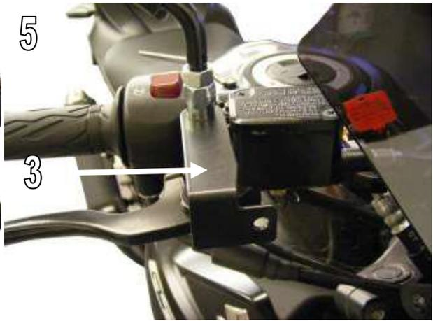
6. Montieren Sie die Handprotektoren mit den Lenkerendeneinsätzen und ziehen Sie die Schraube M6 x 80 (8) fest. Befestigen Sie die Handprotektoren mit den M6 x 20 Schrauben (4) und M6 Muttern (5) an den Halterungen Abb.6 / Fit hand guards using bar end inserts and tighten M6 x 80 cap socket screw (8). Fit the hand guards to the brackets using the M6 x 20 screws (4) and M6 Flange nuts (5) Fig.6
