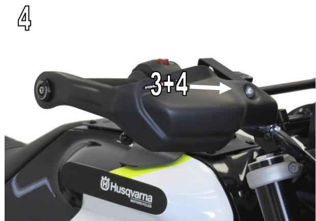
7. Überprüfen Sie die Hebelfunktion, um sicherzustellen, dass kein Widerstand vorhanden ist und die Handprotektoren frei sind Abb.5 / Check lever operation insuring no resistance and that they clear the hand guards Fig.5
