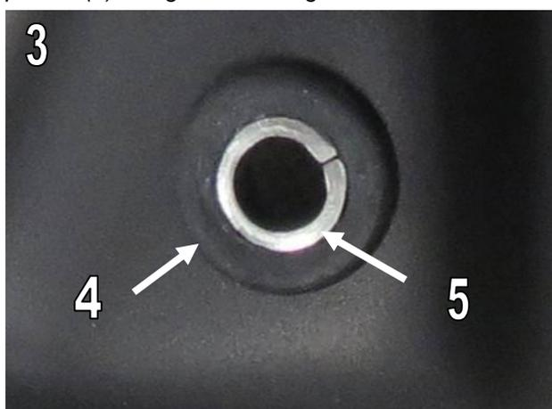
7. Montieren Sie die Handprotektoren mit den Lenkerendeneinsätzen und ziehen Sie die Schraube M6 x 70 (6) fest. Befestigen Sie die Handprotektoren mit den M6 x 20 Schrauben (10) und M6 Muttern (11) an den Halterungen Abb.4 / Fit hand guards using bar end inserts and tighten M6 x 70 cap socket screw (6). Fit the hand guards to the brackets using the M6 x 20 screws (10) and M6 Flange nuts (11) Fig.4
