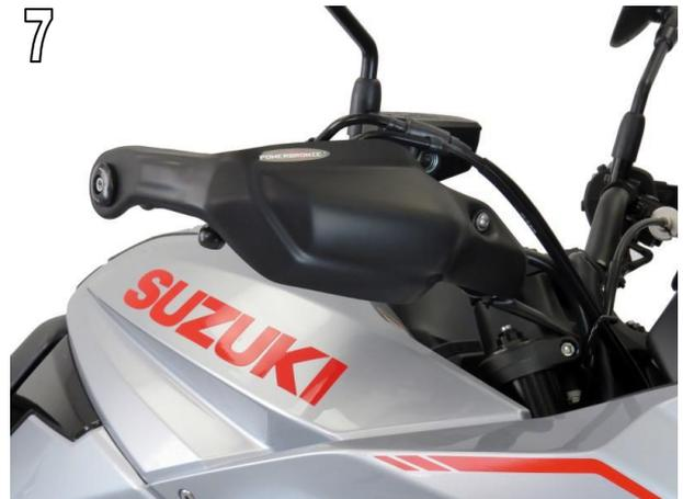
10. Überprüfen Sie die Hebelfunktion, um sicherzustellen, dass kein Widerstand vorhanden ist und die Handprotektoren frei sind. / *Check lever operation insuring no resistance and that they clear the hand guards.*
