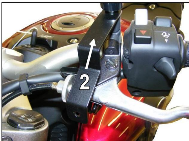
3. In Fahrtrichtung rechts (3) demontieren Sie auf der Unterseite des Bremshebels die Original-Mutter. Montieren Sie dann den Halter an dieser Schraube und befestigen den Halter locker mittels der mitgelieferten M6 Mutter (14).
