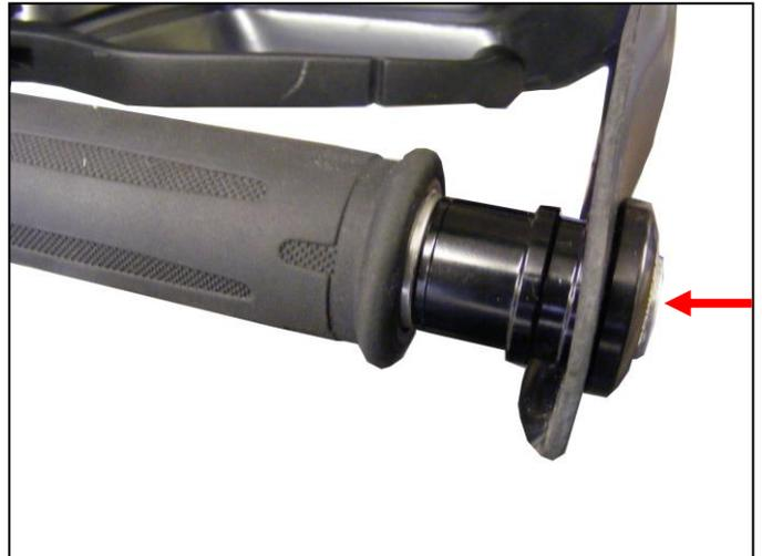
5. Richten Sie nun die Handprotektoren und die Halter zueinander aus und fixieren Sie die Handprotektoren mittels der Schraube M6x20mm (3) und Mutter (4) an den Haltern. Prüfen Sie nun die volle Funktionsfähigkeit der Brems- u. Kupplungshebel und ziehen Sie dann alle Schrauben fest an.
