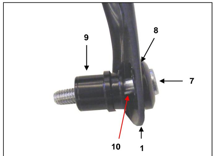
4. Schrauben Sie nun die neuen Lenkerenden mit den Handprotektoren in die Originalgewinde im Lenker locker fest.
