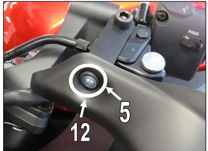
6. Prüfen Sie nun die volle Funktionsfähigkeit der Brems- u. Kupplungshebel und ziehen Sie dann alle Schrauben fest an.
