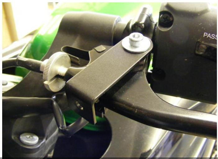
4. Setzen Sie die Gummiringe (6) und Stahlhülsen (7) in die Bohrungen der Handprotektoren ein. Befestigen Sie dann die Montageteile (8)-(11)+(18) zur Lenkerendbefestigung an den äußeren Bohrungen der Handprotektoren und montieren Sie hierüber die Handprotektoren locker am Lenker.
