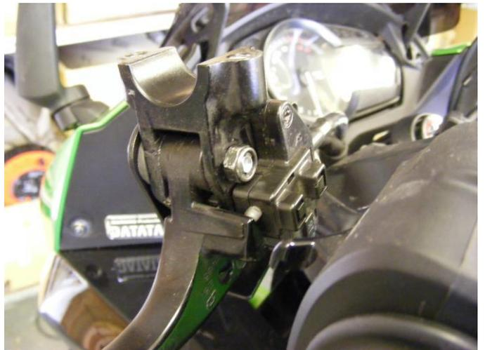
3. Montieren Sie nun den linken Halter (2) mittels der schwarzen Schraube M6x40 (15), der schwarzen U-Scheibe (16) und der Gummi-U-Scheibe (14) auf dem Kupplungshebel und bauen Sie den kompletten Adapter dann wieder am Lenker an.
