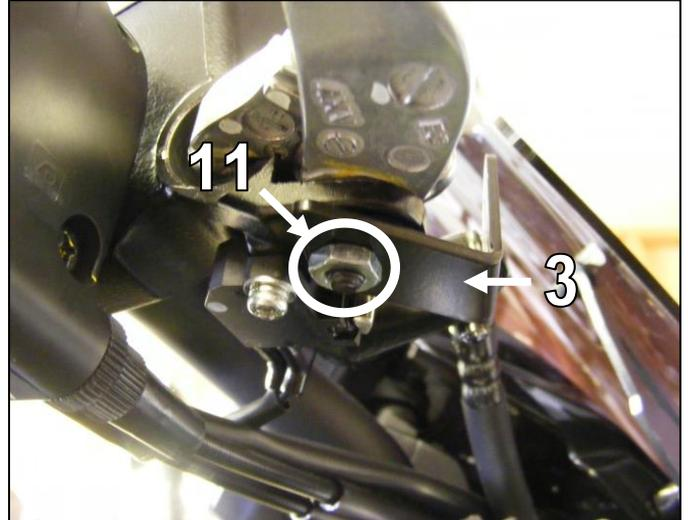
3. Demontieren Sie in Fahrtrichtungen links den Spiegel vom Spiegeladapter und befestigen Sie dann den linken Halter (2) von oben auf dem Spiegeladapter, in dem Sie diesen durch montieren des Spiegels fixieren.
