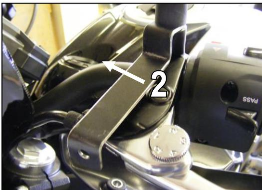
4. Setzen Sie die Gummiringe (6) und Stahlhülsen (7) in die Bohrungen der Handprotektoren ein. Befestigen Sie dann die Montageteile (8)-(10)+(12) zur Lenkerendbefestigung an den äußeren Bohrungen der Handprotektoren, setzen dies dann in das Lenkerende ein und befestigen Sie die Handprotektoren locker am Lenker.
