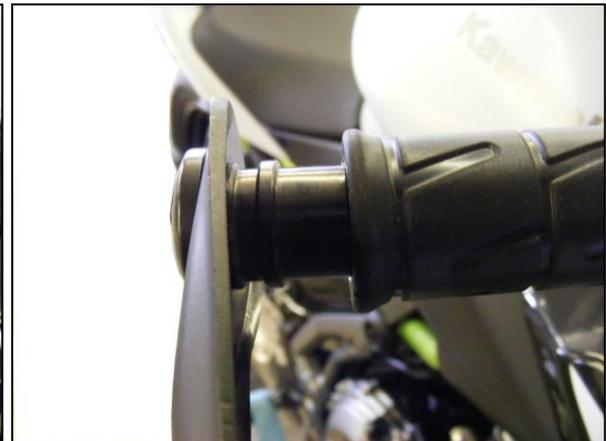
6. Richten Sie nun die Handprotektoren und die Halter zueinander aus und fixieren Sie die Handprotektoren mittels der Schrauben M6x20mm (4) und Muttern (5) an den Haltern. Prüfen Sie nun die volle Funktionsfähigkeit der Brems- u. Kupplungs-Hebel und ziehen Sie dann alle Schrauben fest an.
