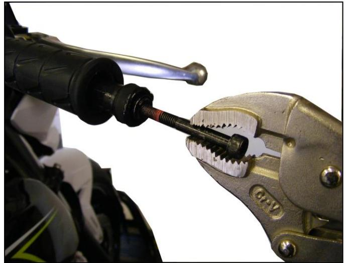
2. Demontieren Sie an der Unterseite des Bremshebels die Befestigungsmutter, legen Sie den Halter in Fahrtrichtung rechts (3) von unten an den Adapter an und befestigen Sie den Halter wieder mit der im Lieferumfang enthaltenen M6 Mutter (11). **Wir empfehlen Ihnen für diese Mutter Schraubensicherung zu verwenden.**
