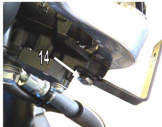
3. Demontieren Sie nun am Kupplungshebel die Befestigungsschraube, legen Sie zuerst eine U-Scheibe (9) und den Halter in Fahrtrichtung links (2) auf den Adapter und führen Sie die Originalschraube wieder komplett bis nach unten durch. Sichern Sie die Schraube mittels der M6 Mutter (14).
