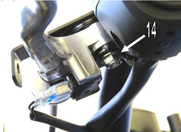
4. Setzen Sie die Gummiringe (6) und Stahlhülsen (7) in die Bohrungen der Handprotektoren ein. Befestigen Sie dann die Montageteile (8)-(13) zur Lenkerendbefestigung an den äußeren Bohrungen der Handprotektoren, setzen dies dann in das Lenkerende ein und befestigen Sie die Handprotektoren locker am Lenker.
