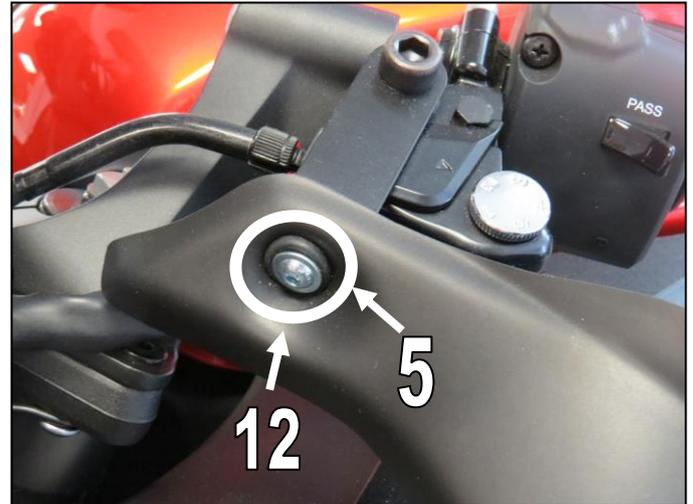
1. Prüfen Sie nun die volle Funktionsfähigkeit der Brems- u. Kupplungs-hebel und ziehen Sie dann alle Schrauben fest an.
