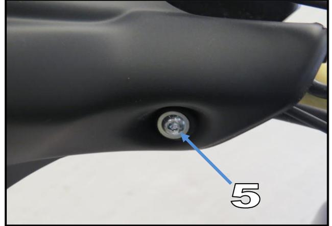
5. Prüfen Sie nun die volle Funktionsfähigkeit der Brems- u. Kupplungshebel und ziehen Sie dann alle Schrauben fest an.
