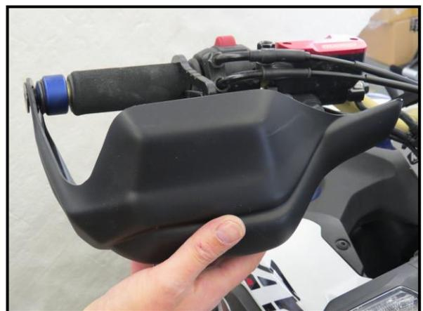
4. Richten Sie nun die Handprotektoren an der unten gezeigten Aufnahme aus und fixieren Sie diese mittels der Schraube M6x20mm (5).
