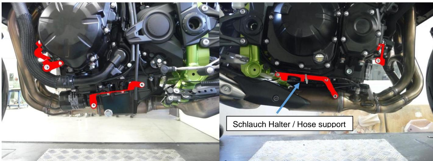
**Der Bugspoiler muss im montierten Zustand ausreichend Platz zu Motor und Auspuffanlage haben. / Once fitted, the belly pan must have enough space to the engine and the exhaust system.**
