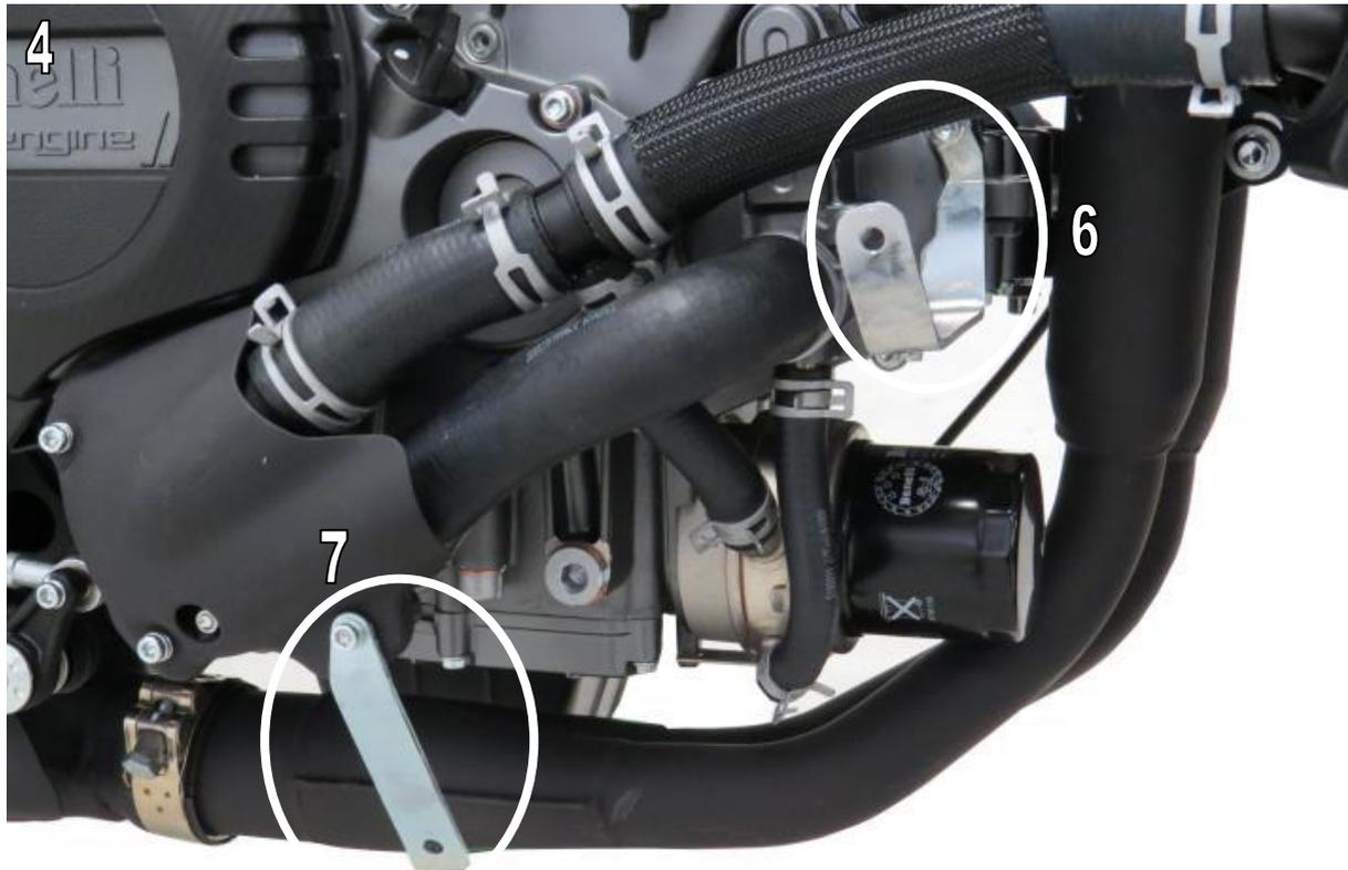
6. Montieren Sie den Bugspoiler an den Haltern mittels der M6 x 20mm Schrauben (11) und M6 Muttern (10) an den Haltern. Sobald der Bugspoiler korrekt ausgerichtet ist, ziehen Sie alle Halter fest. / *Fit belly pan to brackets using M6 x 20 socket flange screws (11) and M6 flange nuts (10) to secure belly pan to brackets. Once positioned correctly, fully tighten all brackets*
