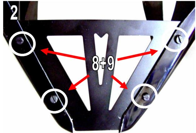
5. Befestigen Sie die Halter wie auf den Bildern dargestellt anhand der Originalschrauben. / *Fix brackets using original fixings as shown in Fig.3 & 4.*
